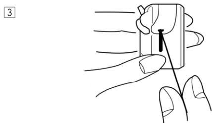
1. Stavite kalem u kućište
