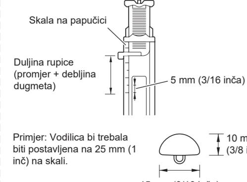
Primjer: Vodilica bi trebala biti postavljena na 25 mm (1 inč) na skali.
